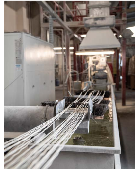
Sattler setzt ausschließlich auf Stranggranulieranlagen, da diese bei häufigen Produktumstellungen flexibel einsetzbar und schnell gereinigt sind.
