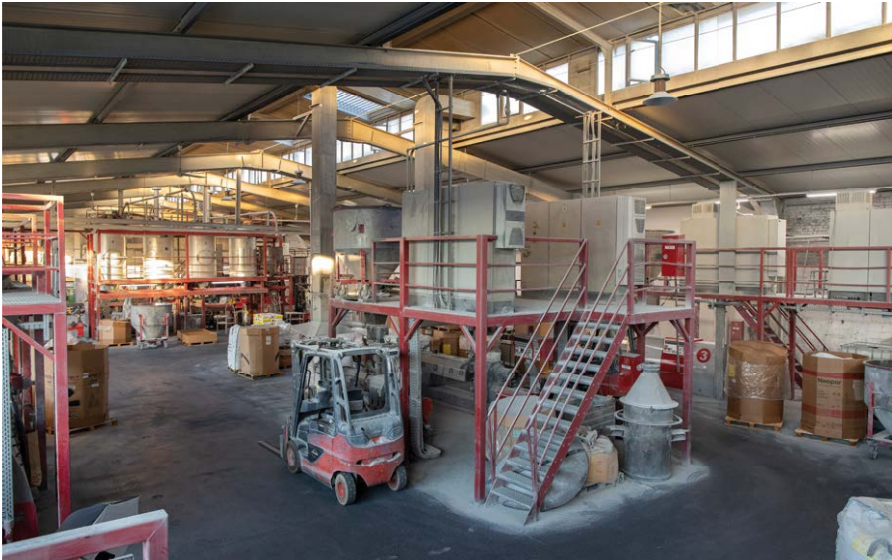
In Mühlheim am Main stehen sechs Doppelschneckenextrusionsanlagen für die Herstellung der Compounds für hochwertige Nischenanwendungen.
